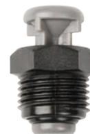
**Правильная установка воздушных/ вакуумных предохранительных клапанов:** Найдите самую высокую точку (точки) в зоне трубопровода системы капельного орошения. Чтобы воздушный/ вакуумный предохранительный клапан эффективно работал на всех рядах трубопроводов системы капельного орошения, установите его на возвратный коллектор или трубопровод, перпендикулярный отводам.
