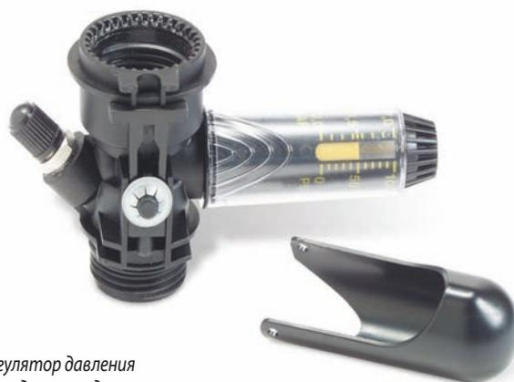
*\* Несмотря на то, что регулятор давления PRS-Dial может удерживать давление до 13,80 бар, точная регулировка может быть достигнута только до 6,90 бар.*
